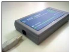
Acople el conector mini-USB al módulo de adquisición (en el extremo etiquetado como **computer**). Deberá encenderse el led indicador de funcionamiento.
